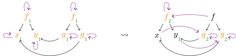
FIGURE 11. Étape (2) de l'algorithme d'unification de HUET sur les termes d'entrée f(x, y) et f(g(y), g(x)) .
