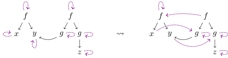
FIGURE 6. Étape (2) de l'algorithme d'unification sur les termes d'entrée f(x, y) et f(g(y), g(z)) .
